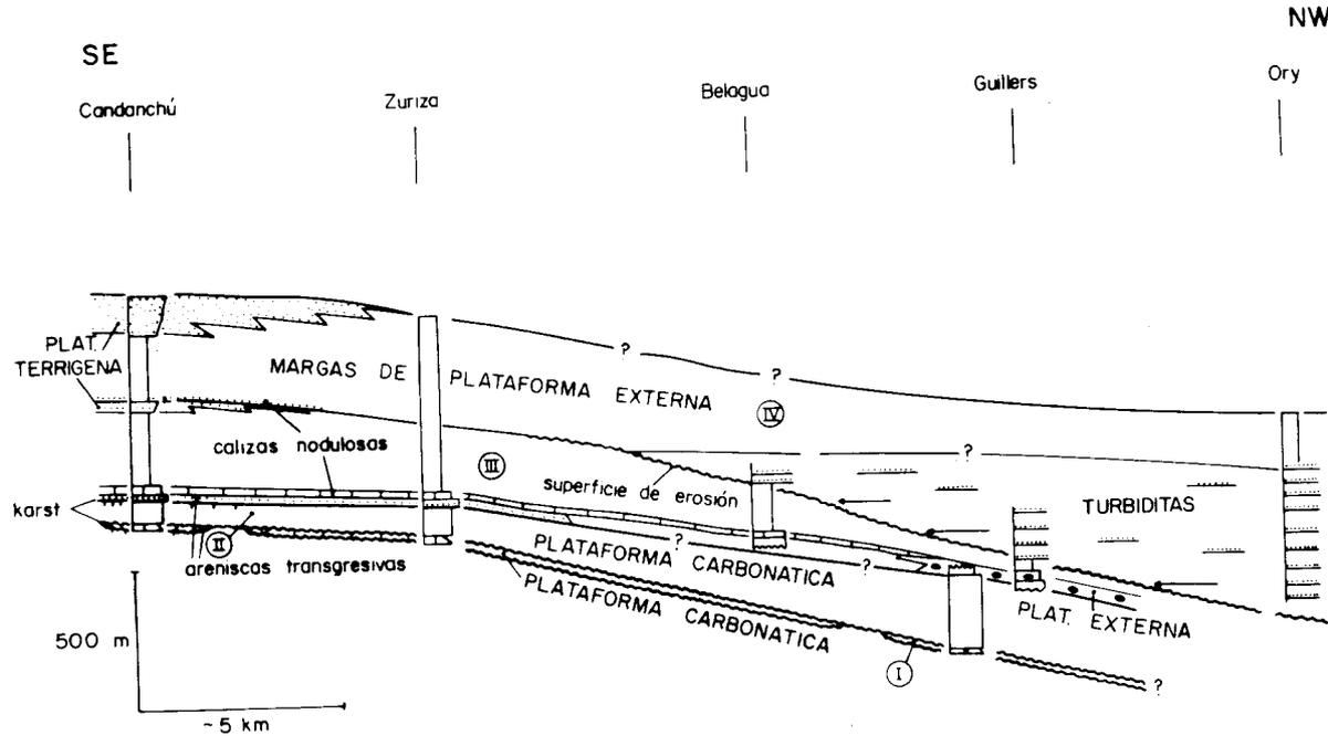
Fig. 2.- Esquema estratigráfico mostrando la relación entre los diferentes sistemas deposicionales del Cretácico superior de la hoja de Ansó y sectores situados más al norte (hoja de Zuriza). I: Cenomaniense; II: Coniaciense superior-Santonense inferior; III: Santoniense superior-Campaniense medio; IV: Campaniense superior-Maastrichtiense.
